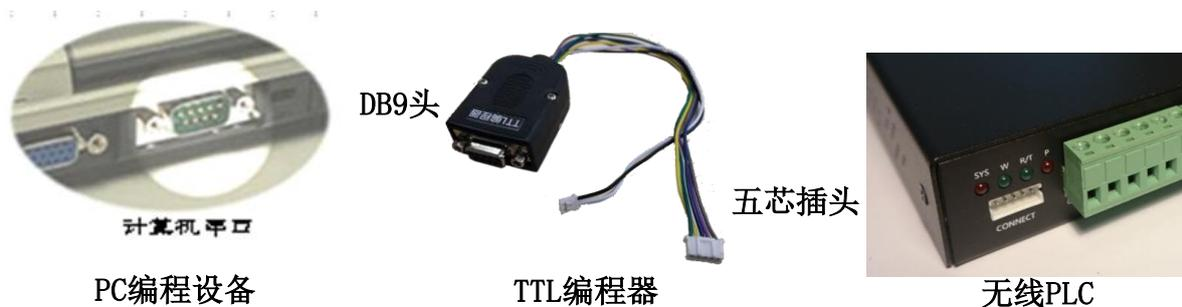
图 4-1 无线 PLC 与编程设备连续示意图
