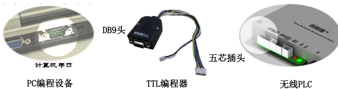
图 4-1 无线 PLC 与编程设备连续示意图
