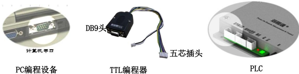
图 2-1 TTL 编程器与编程设备连接图
