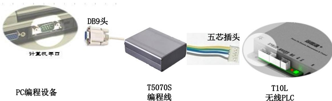
图 2-2 T10L 与编程设备连接实物图
